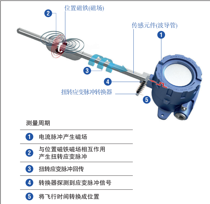
图1：基于飞行时间的磁致伸缩位移传感原理
