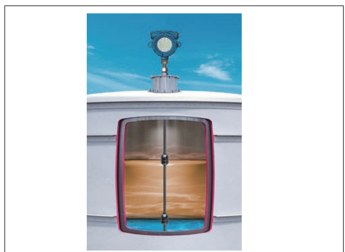
图2: 产品液位和分界面液位测量的示例
