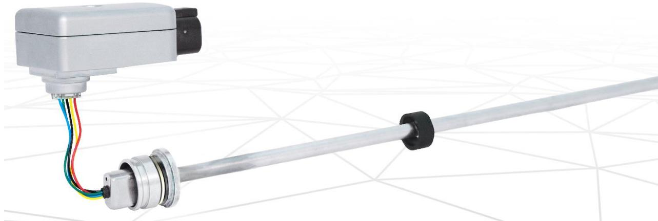
Tempsonics 传感器公司，磁致伸缩传感技术的先驱及领先的非接触式线性位移传感器制造商，宣布推出全新磁致伸缩传感器——MH 系列 分体式传感器，该产品专为行走机械的液压缸开发，易于现场维护和更换。该传感器采用分体式设计，感应元件（安装在缸体内部）独立于外部电子模块。只需通过拆卸单个螺丝和插头，即可快速更换电子模块，无需额外校准或重新设定，实现即插即用的功能。
