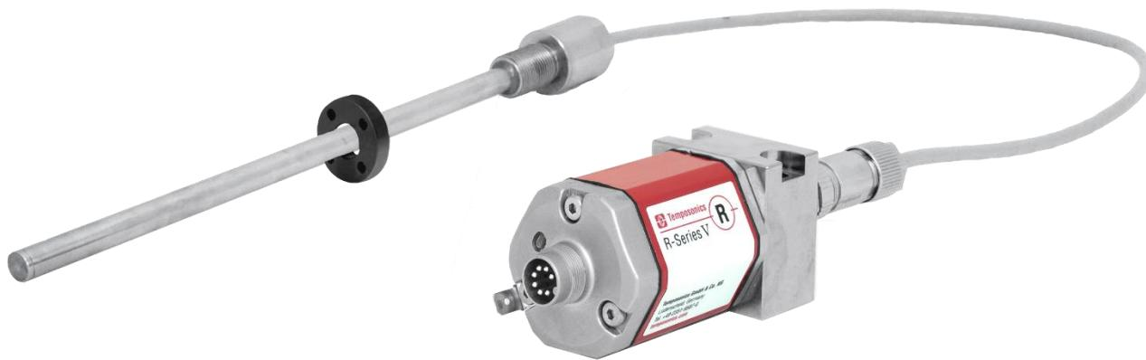
在工业生产中，工程师常面临安装空间狭窄和极端工作温度的挑战，这使得应用传感器变得异常困难。R 系列 RD5 传感器专门为克服这些障碍而设计。通过电子元件与传感元件分体式设计，可将电子头远距离安装——最远可距离测杆 20 米——安全地置于高温区域之外，或在空间受限时安装在有足够空间的位置。传感元件可在高达 120° C 的环境温度下运行，使得 RD5 传感器在传统产品通常无法胜任的条件下仍能提供精确可靠的位置测量。为金属成型、压铸以及其他因高温或安装空间受限的苛刻应用场景提供了高性能位移测量解决方案。
